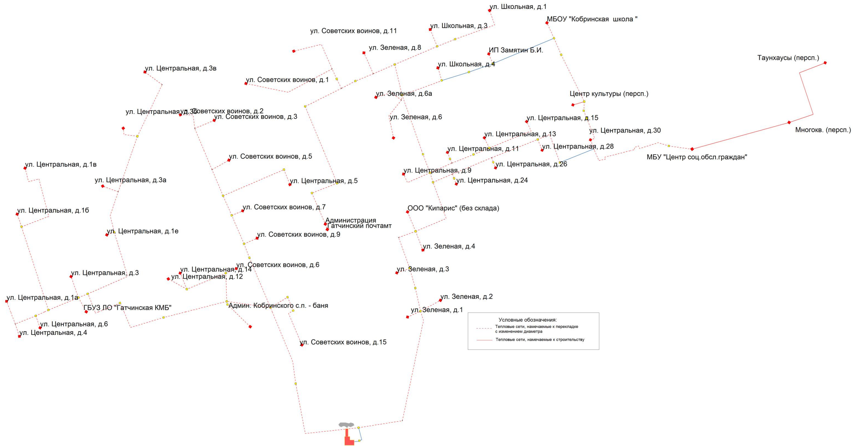
Рисунок 4.5. Схемы тепловых сетей котельной №11 пос. Кобринское на 2030 год (контур отопления)
